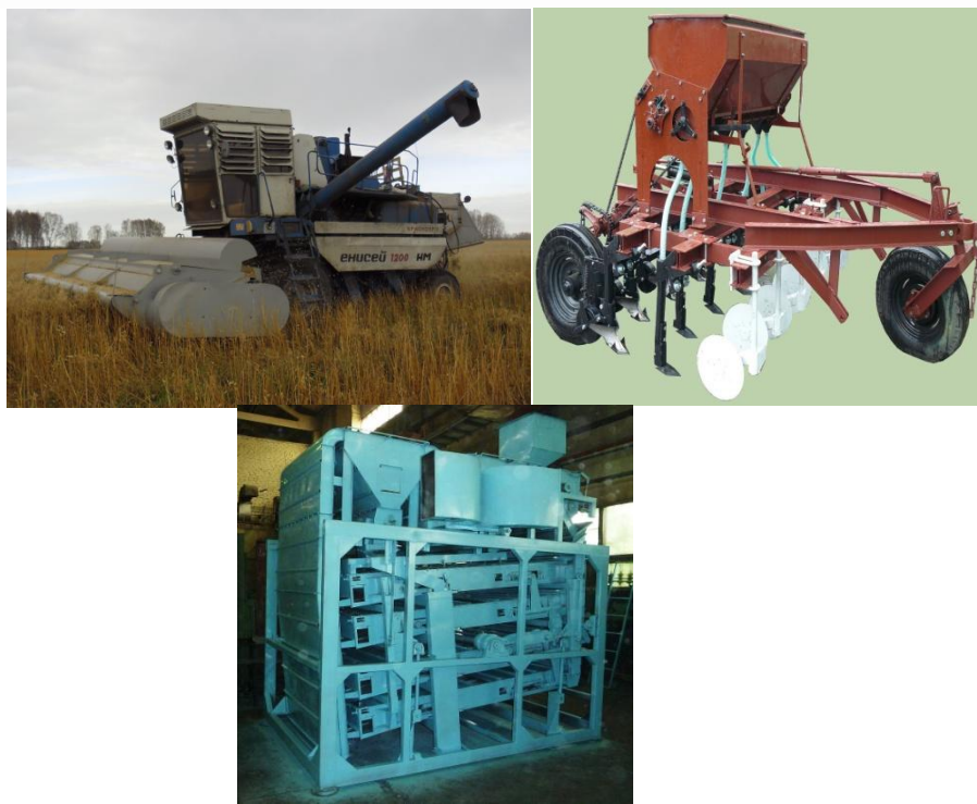
Рисунок 5. Импортозамещающая техника: очесывающая жатка «Сибирь», машина для полосно-разбросного посева семян трав; зерноочистительная машина ЗМ-20/10
