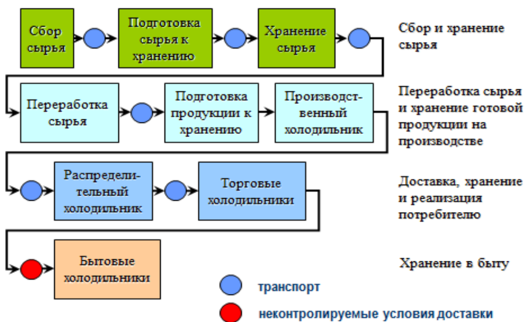
Рисунок 2. Принципиальная схема холодильной цепи
